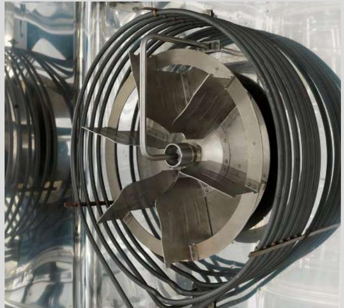
Ventola in camera di cottura ad alta efficienza aerodinamica con inversione di rotazione per una maggiore uniformità di cottura.
